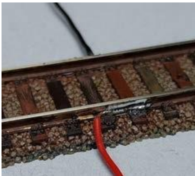
Detalhe: Cabo de alimentação soldado à face externa do carril.
